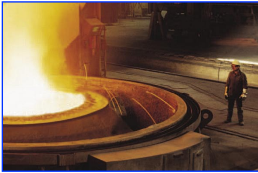
Wo aus flüssigem Roheisen Stahl wird: Konverterbetrieb bei HKM (8)
