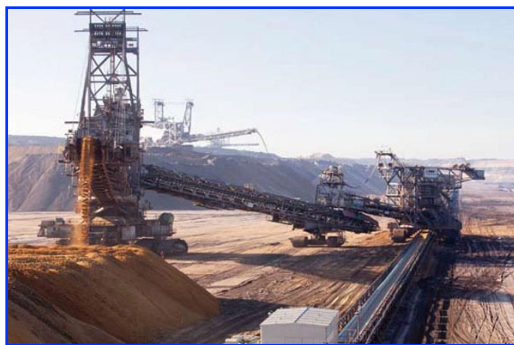
Absetzer auf der Verkippsseite: Sie verteilen den Abraum – Kies, Sand und Ton – zur Vorbereitung der späteren Rekultivierung. (4)
